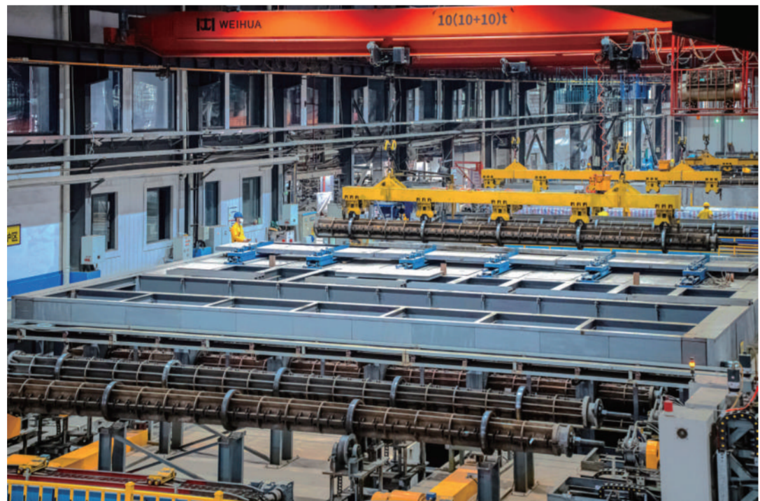
在北海精一公司的智能工厂内，行车将电杆钢模吊装。廖思宇 摄
