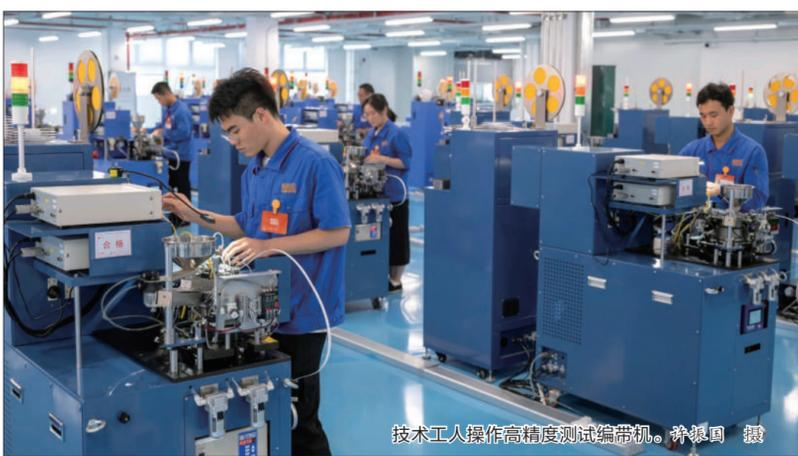
技术人员操作高精度测试编带机。许振国 摄
